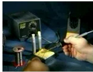
加锡步骤很重要，保证烙铁头润湿焊件的第一步。
