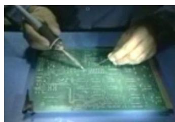
烙铁轻轻地接触焊点
