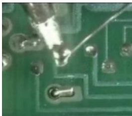
烙铁头加焊锡
